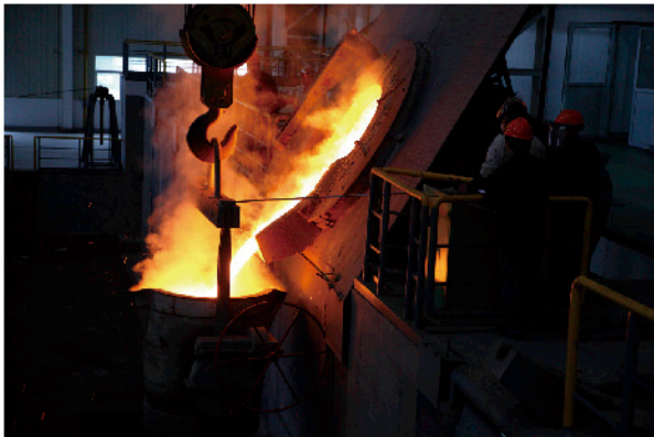
螺旋桨浇注 Propeller casting
