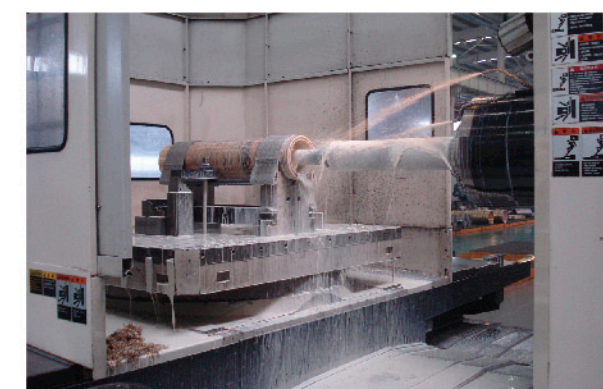
加工轴套 Shaft bush machining
