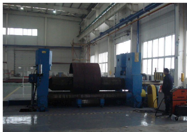
钢板卷制 Steel plate rolling
